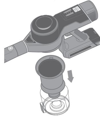
4. Spülen Sie den Staubbehälter und den Metallfilter mit Wasser aus und lassen Sie die Teile anschließend trocknen. Vergewissern Sie sich, dass die Teile vollständig getrocknet sind, bevor Sie sie wieder einsetzen.
