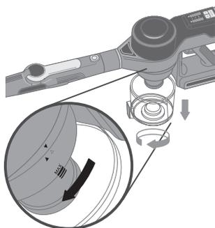
2. Drehen Sie den Staubbehälter im Uhrzeigersinn, um ihn zu entfernen. Entfernen Sie verbliebenen Staub und Schmutz.
