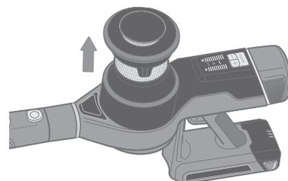
2. Drehen Sie den Hauptfilter gegen den Uhrzeigersinn, um ihn aus dem Gehäuse zu entnehmen.
