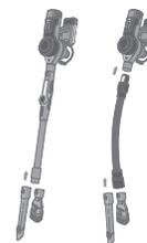
4. Wahlweise kann das Saugrohr entfernt und der Verlängerungsschlauch am Hauptgerät befestigt werden. Befestigen Sie anschließend die Fugendüse oder die Staubbürste am Ende des Verlängerungsschlauchs.
